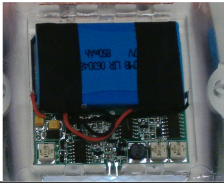
Figuur: Electronica ingegoten met ransparante PUR
